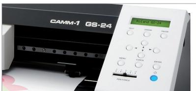
Il nuovo pannello LCD permette all'operatore di gestire tutte le principali funzioni della periferica, aumentando notevolmente la produttività. Un supporto portarotolo in dotazione assicura il corretto scorrimento del materiale, permettendo
